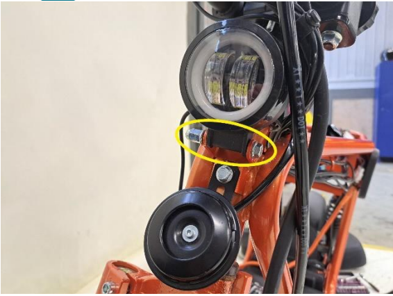
Irrota etuvalon kiinnityspultti (kiintoavain 10 mm).
