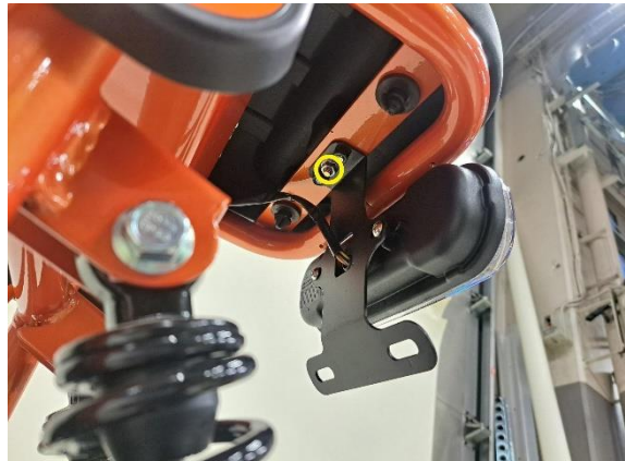
Irrota istuimen kiinnitysmutteri (kiintoavain 10 mm).
