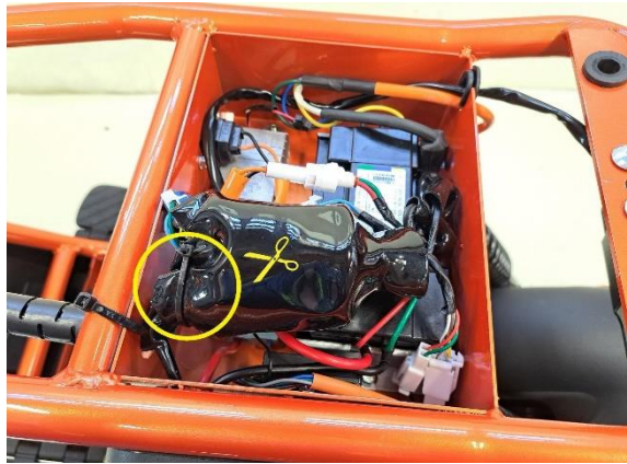
Katkaise johtojen suojaa kiinni pitävä nippuside (sivuleikkurit).
